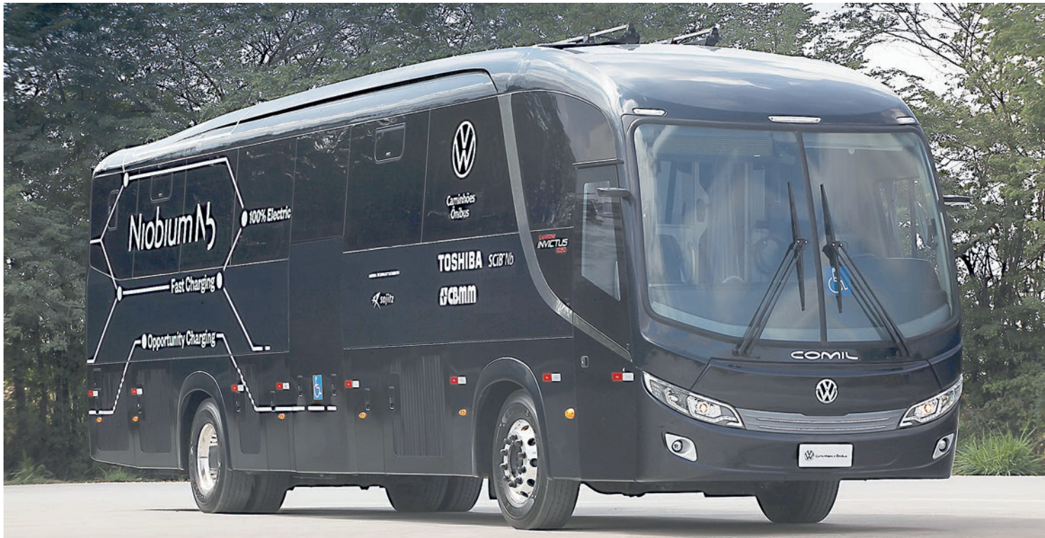
Tecnologia inédita permite que as baterias tenham uma recarga ultrarrápida, em que se pode atingir a autonomia máxima do veículo (cerca de 60 quilômetros) em menos de 10 minutos FOTO: DIVULGAÇÃO / VOLKSWAGEN CAMINHÕES
